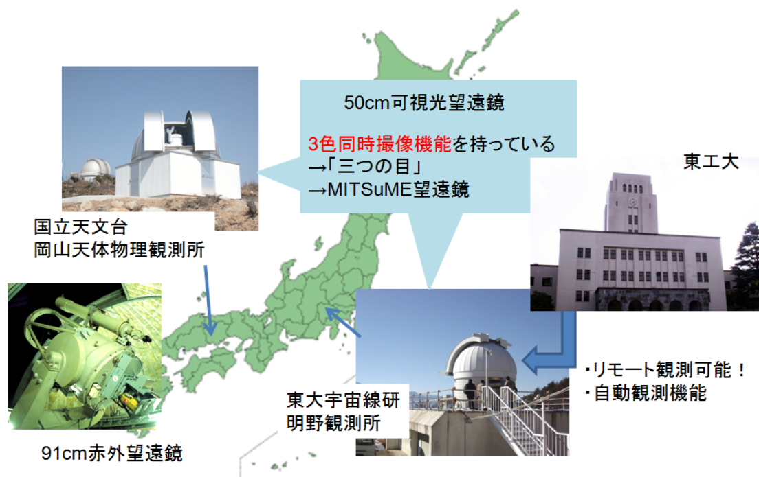
図 2.1: MITSuME 望遠鏡。3つの望遠鏡のうち、我々は明野望遠鏡の開発、運用を担当している。大きな特徴として3色同時撮像機能と自動観測機能を持っていることが挙げられる。また東工大と明野望遠鏡はADSLで繋がっておりリモート観測が可能となっている。
