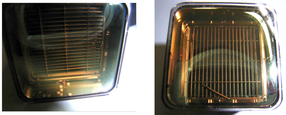
図 5.4: 破損した MAPMT。ダイノードの支持電極と思われる丸い部品 (左) と収束メッシュ (右) が取れている。
