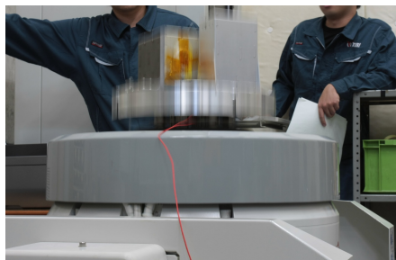
図 5.1: 第1回振動試験の様子。機軸方向と機軸直交方向で加振を行った。試験機はIMV i230/SA2Mを使用した。
