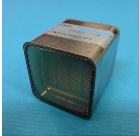
図 3.5: MAPMT R8900-M16 MOD-UBA。1 辺 \sim 26mm。HXCP では 4 つの MAPMT で 8 \times 8 ピクセルの散乱体が構成される。
