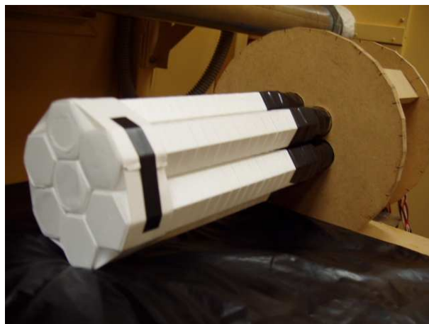
図 4.2: 7 ユニットプロトタイプ偏光計
