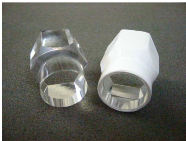
図 3.1: アクリルライトガイド。右は反射材を巻いたもの。
