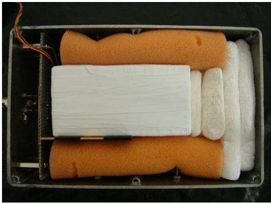
図 5.1: APD+大型 BGO、温度センサーが入っている治具の内部。両側と後ろに綿を詰めて BGO が動かないように固定している。
