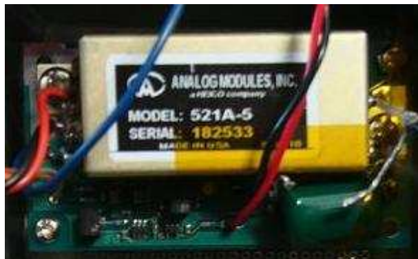
図 4.2: 実験に用いた DC/DC の写真。DC/DC に入力された電圧を 120 倍したものが APD の印加電圧となる。
