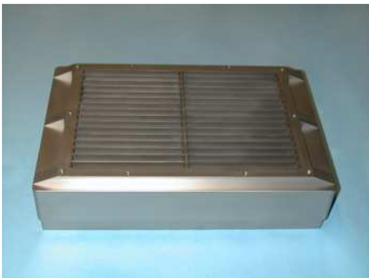
図 3.2: GSC カウンタの概観。受光面となる Be 膜を支えるため棧が設けられている。
