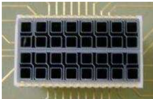
図 5.1: 浜松ホトニクス社製 32素子アレー型 APD S8550
