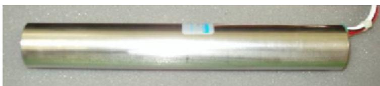
図 3.9: 実際に製作された光電子増倍管の試作品。高圧電源が内蔵されている。長さはおよそ 20cm。
