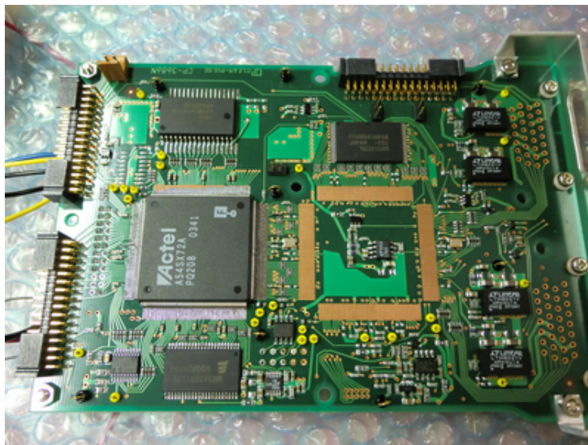
図 4.2: CPU 基板の写真。図中左側にある、正方形の大きな素子が CPU-FPGA である。図中左側のコネクタにバックプレーン基板が、図中上側のコネクタにサイドプレーン基板が接続する。回路ボックス内の 4 枚の基板は、全てこの基板と同じ形をしている。
