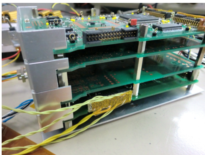
図 4.3: 回路ボックスを構成する基板4枚の構成例。上から、CPU基板、WBMロジック基板、WBM電源基板、電源基板と並ぶ。ただし、写真中ではWBMロジック基板、WBM電源基板がダミー基板になっている。回路間は、コネクタと金属のスペーサーで接続されている。各基板にはそれぞれコネクタ取り付け用のアルミ板が取り付けられる(図中左側)。
