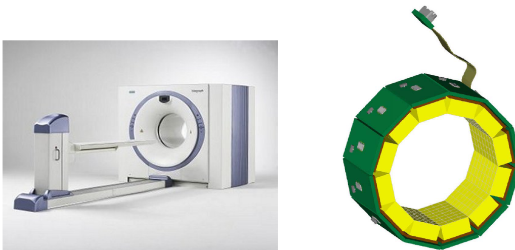
図 4.2: 拡張型 PET の概念 (左) 従来の PET 装置 [50] (右) 拡張型 PET [51]
