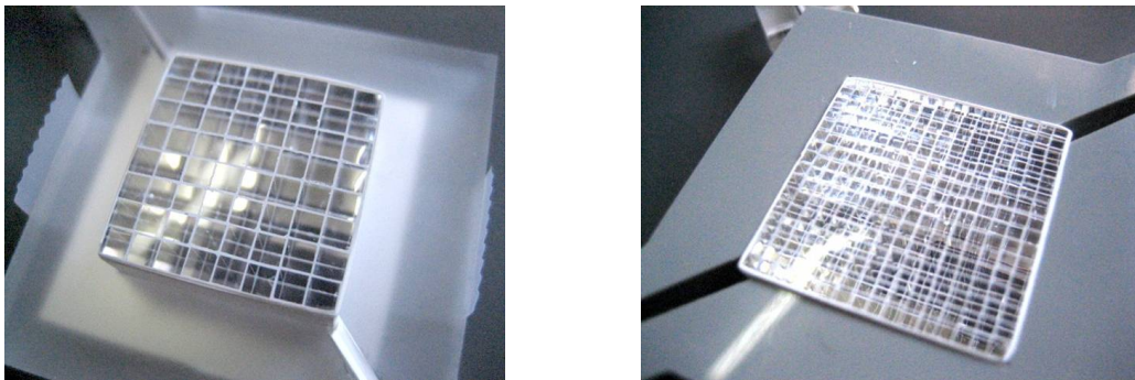
図 4.5: 今回試作を行った LYSO ピクセルシンチレータ・アレー 2 種類。専用の組み上げ用治具に収められている。(左)8×8 ch (右)16×16 ch
