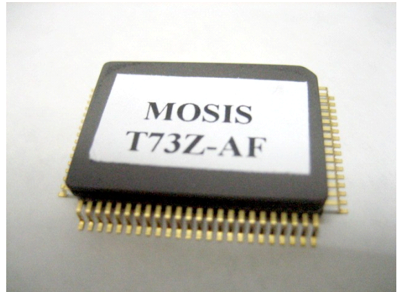
図 4.32: 完成した TIPPET08 チップ。(左) ベアチップの写真。チップサイズは 2.85 \times 2.85 \text{ mm}^2 である。(右) 80 pin のセラミックパッケージに封入後に試験を行った。パッケージサイズは 14 \times 20 \text{ mm}^2 である。
