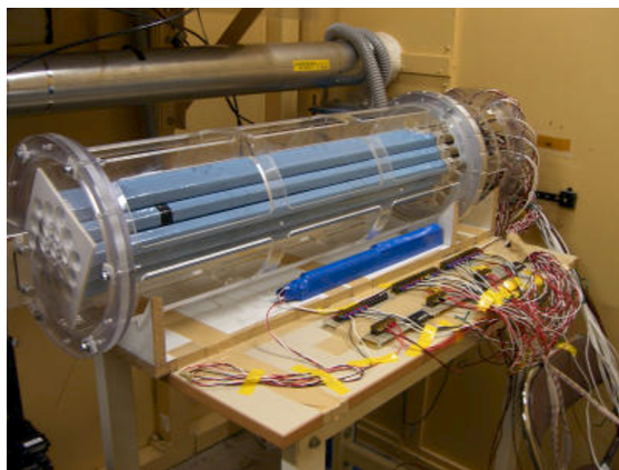
図 3.1: 2008 年 2 月の KEK 実験における PoGOLite フライトモデル PDC19 ユニットの写真
