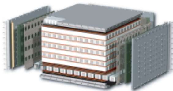
図 2.5: Calorimeter の配置図。棒状の CsI 結晶がレイヤー毎に 90 度ずつ向きを変えて並べられている。
