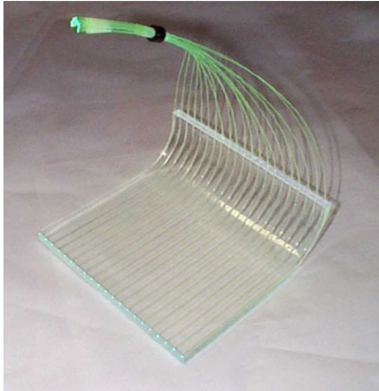
図 2.6: ACD に使われるプラスチックシンチレーターと wavelength-shifting fiber
