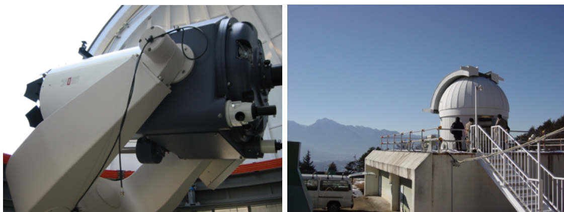
図 2.3: 左図：明野 50cm 望遠鏡。カセグレン式反射望遠鏡。架台部はフォーク式赤道儀。右図：明野ドーム。
