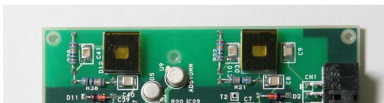
図 2.15: Cute-1.7+APDII 搭載 APD の遮光治具。写真では表面にカプトンテープが貼られており、埃などから保護されている。カプトンテープは打ち上げ前の最終試験にて、APD モジュールからはがして打ち上げに臨んだ。2 つの APD の間にある素子が温度センサ AD590 である。
