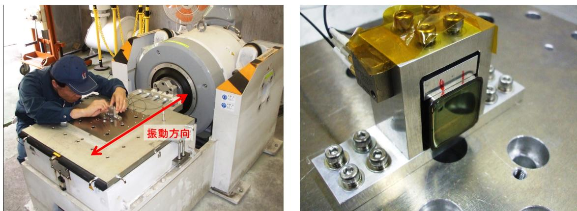
図 5.34: 振動試験での加振機付近様子と治具に固定された MAPMT の様子。MAPMT を押さえつけるネジは、MAPMT を押さえつけすぎないように少し緩めに締めてあるので、はずれないようにカプトンテープで固定してある。
