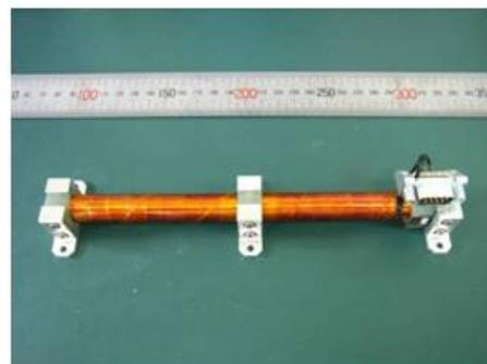
図 6.11: MTQ。コイルに電流を流すことで磁界を発生させ、外部磁場との相互作用を利用してトルクを発生させる人工衛星の制御デバイス。
