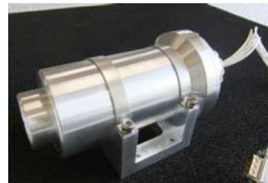
図 1.2: 姿勢制御用の小型 CMG。定速回転するホイールを支持しているジンバルを回転させることで、ジャイロ効果によるトルクを生み出すデバイスである。
