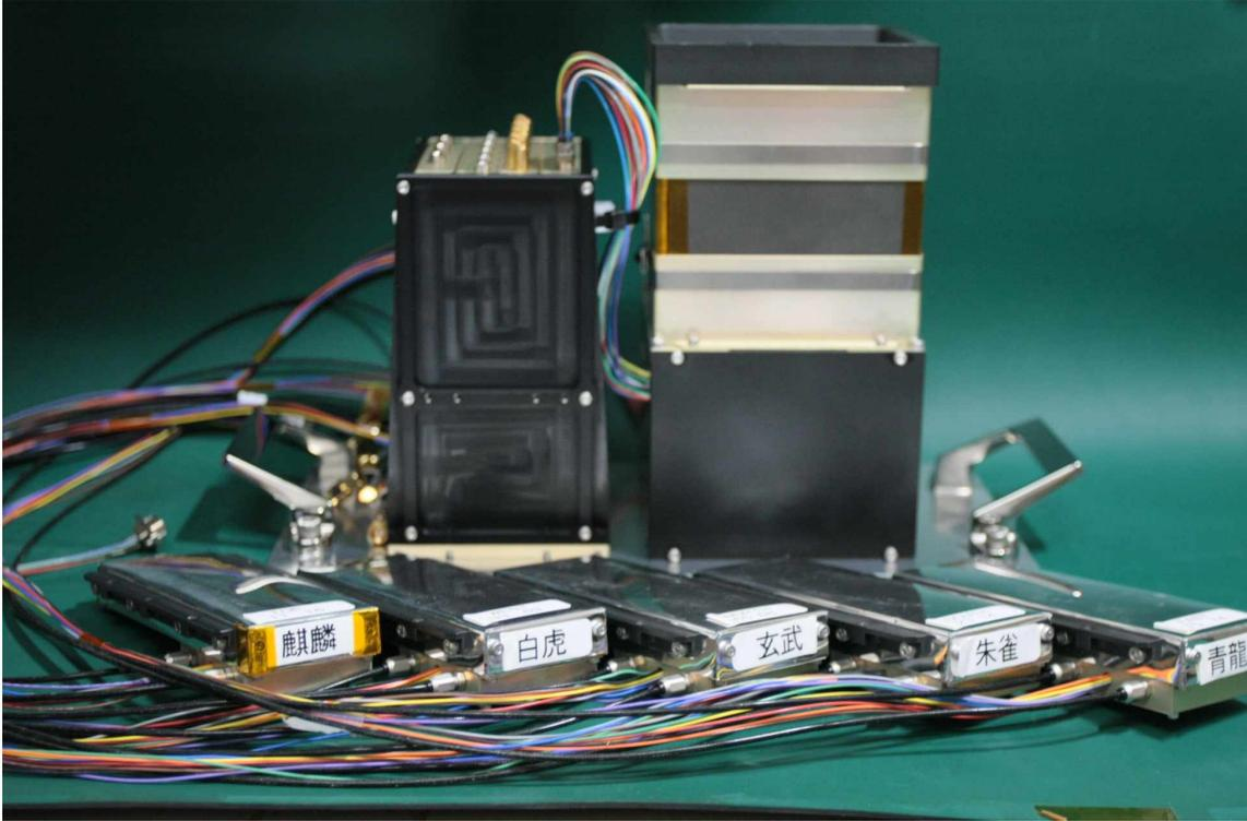
図 3.2: ガンマ線観測系の検出器の写真。中央左が回路ボックスで、中央右が HXCP、下の 5 つが WBM である。
