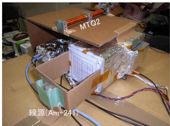
図 6.13: MTQ1 の位置関係を模擬して配置。図 6.14: MTQ2 の位置関係を模擬して配置。
