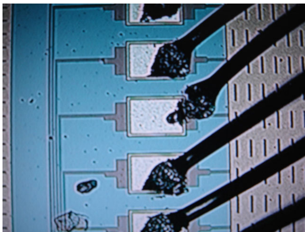
図 5.5: ボンディング部分の拡大図。パット部分からはみ出ているワイヤがある。
