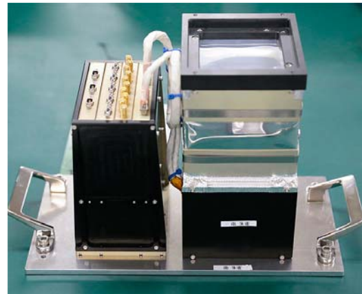
図 3: TSUBAME に搭載された硬 X 線偏光計
