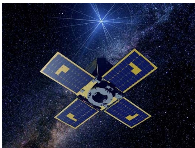
図2: Tsubameの想像図。CMGによる高速姿勢制御が突発天体の観測を可能にします。
